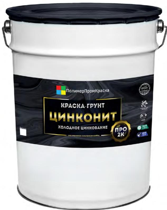
**Краска-грунт Цинконит Про 2К** – двухкомпонентный полиуретановый состав на органическом растворителе, в который внесен высокодисперсный активированный порошок цинка (96% в сухом остатке), что позволило добиться эффекта холодного цинкования: катодной защиты металлических поверхностей от коррозии.
